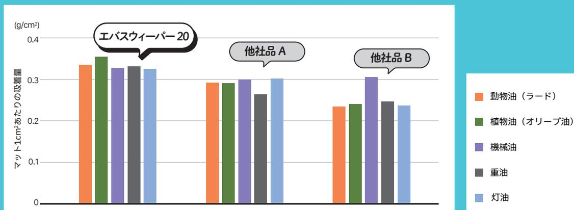
エバスウィーパー20は、界面油の除去、油類漏洩時の拭き取りなど、満遍なく高い吸着性能を示します
