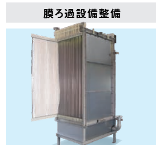
膜ろ過施設の薬品洗浄等定期整備により、施設機能を維持
