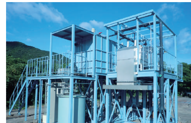
● 低コスト型高効率油水分離装置「YBプロセス」
