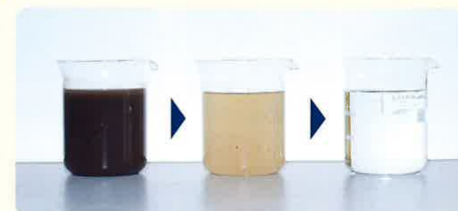
し尿・浄化槽汚泥 分離液 放流水 (生物処理水)
