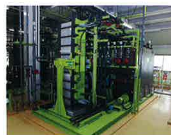
●電気透析濃縮装置(ED) 精密ろ過膜処理水をイオン交換膜に通水し、直流電流を流すことで、脱塩・濃縮を行います。
